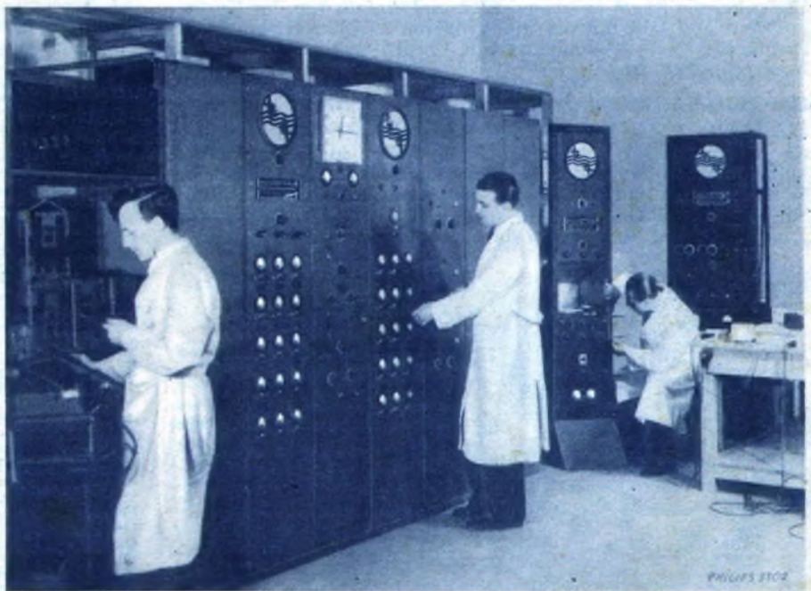
Auch große Verstärkeranlagen werden vor dem Einbau in der Werkstatt betriebsfertig zusammengebaut, um Leistung und zuverlässige Arbeitsweise zu erproben. (Werkbild)
