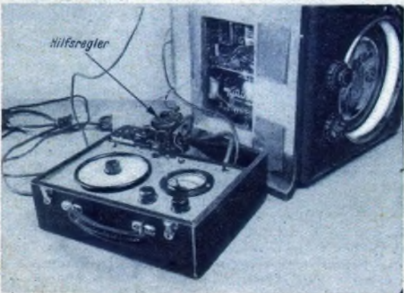
Das neue Verfahren in der Praxis: Der Hilfsregler zur Handregelung der Empfängerverstärkung steckt auf dem Stromversorgungsteil des Prüfgenerators (Werkbild)
